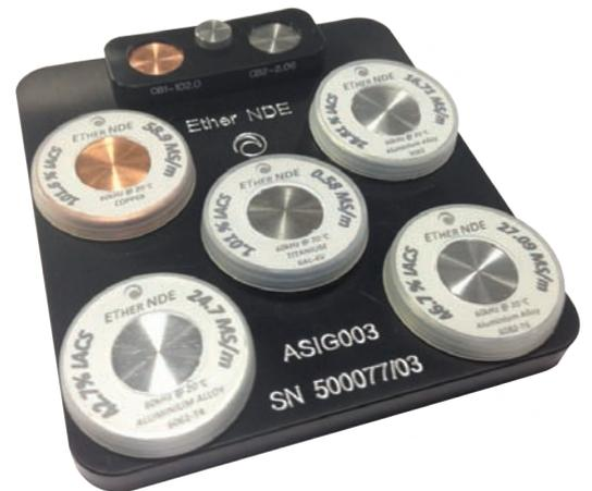
支架内的电导率测试砌块
